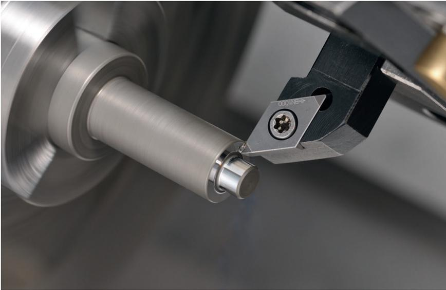
**1** In mehreren anspruchsvollen Branchen bewährt es sich bereits, das binderlose CBN. Seine dicht >gepackten< Nanokörner bewirken eine sehr hohe Wärmeleitfähigkeit der Wendschneidplatte und reagieren träge auf viele Elemente im Werkstück (© Sumitomo)
